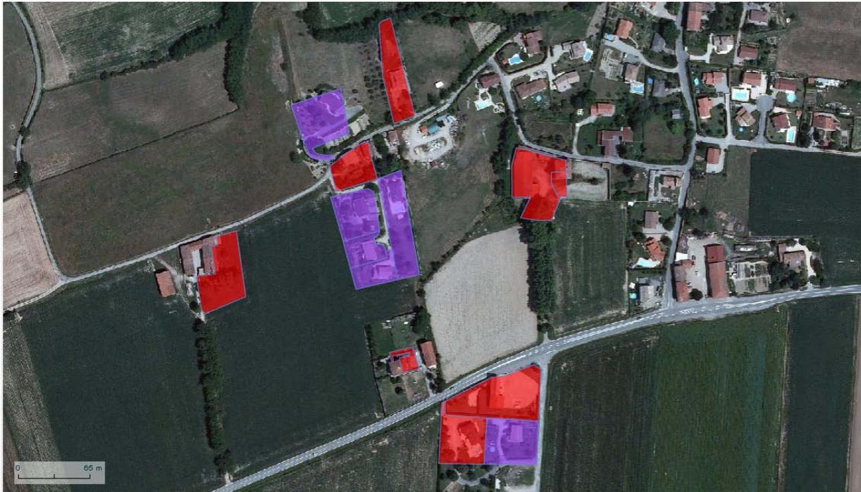
Il est envisagé la réalisation d'un réseau PVC CR8 Ø200 gravitaire, sous une chaussée revêtue étroite, ce qui nécessitera de couper complètement la route. Une étude topographique assez fine sera nécessaire et l'aspect géotechnique n'est pas à négliger car l'étroitesse de la route et son aspect « cabossé », sous entendent un réseau potentiellement profond, susceptible d'affecter la murs des habitations les plus proches.
